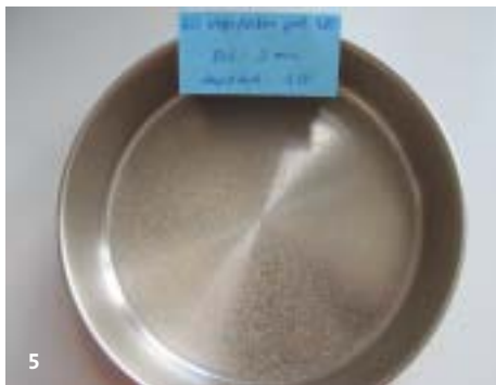
AS 200 control im Einsatz: Bei der Siebung von Biohaferflocken (Prozesszeit 120 s, Amplitude 1,00) entstandene Flockenfraktion, von Siebüberstand (Bild 1) bis Staubanteil (Bild 5)
