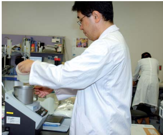
Die Messermühle Grindomix GM 200 wird für die Homogenisierung von Fisch eingesetzt.
