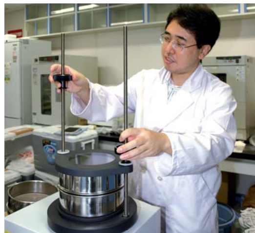
Dr. Takahashi siebt Bodenproben mit der Analysensiebmaschine AS 200
