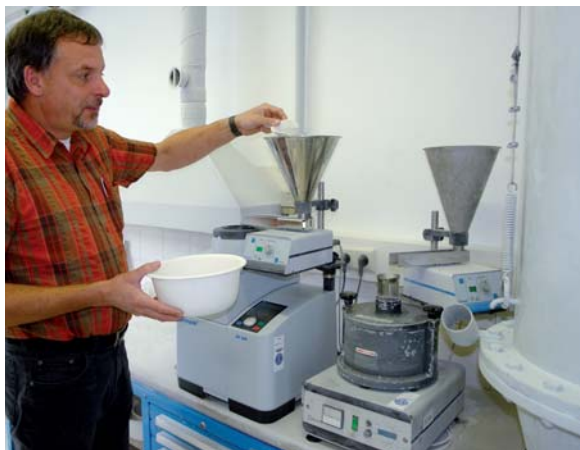
Deux générations : le broyeur ZM 1 des années 80 et l'actuel ZM 200
